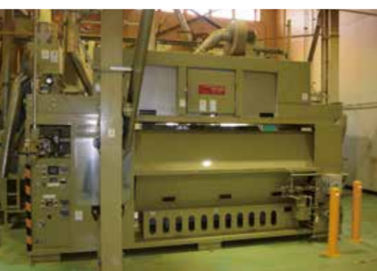
従来の乾燥機に比べ水質を損なわずに火入れできる「マイクロ波遠赤外線乾燥火入れ機」
